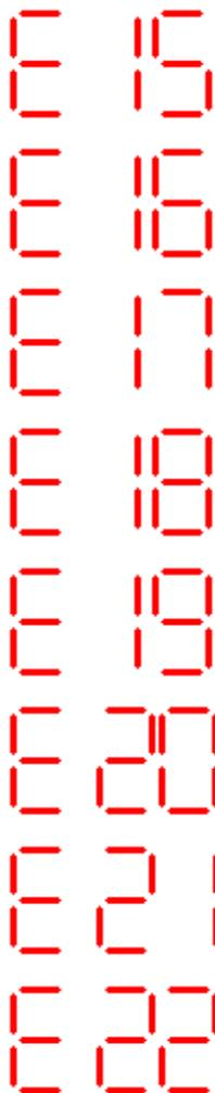
Survitesse ou erreur CAN: le moteur a dépassé la vitesse nominale du moteur en mode couple ou le temps de réponse du contrôleur CAN est dépassé.
